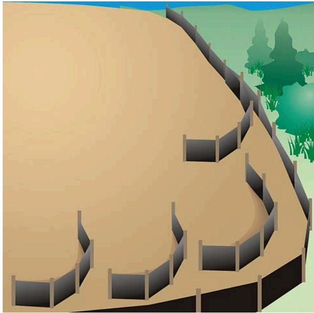
Las barreras contra sedimentos no tienen que estar en el límite de la propiedad. Colocarlos en pendientes con los extremos hacia arriba para atrapar el flujo de láminas proporciona un mejor rendimiento. Escalone las secciones de la cerca para garantizar una cobertura total. Limpie cuando el sedimento alcance un tercio de la altura de la cerca. Repare según sea necesario y retírelo cuando el césped esté bien establecido.
