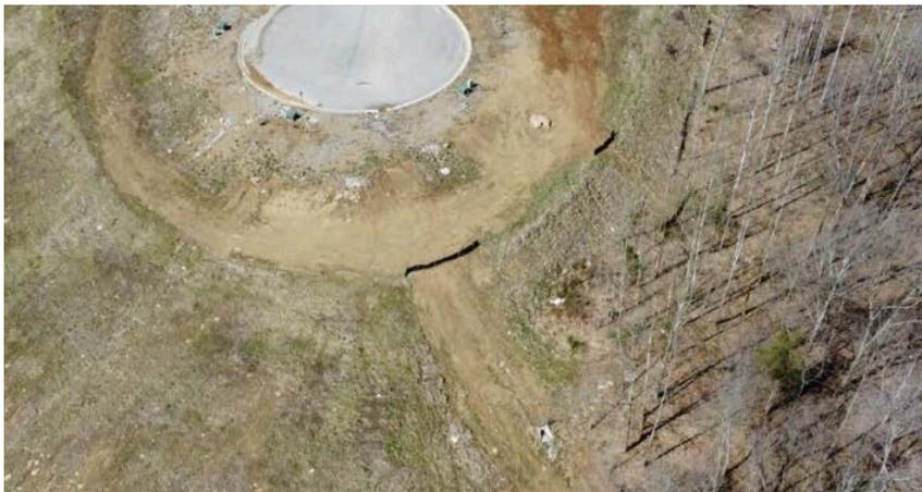
La cerca contra sedimentos solo se colocó en áreas donde ya se estaba produciendo erosión y no en todo el sitio.
