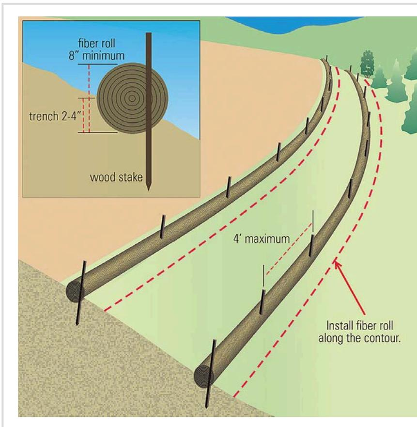
Se pueden utilizar rollos de fibra para romper los flujos de escorrentía en pendientes largas. Instale en el contorno y haga una zanja ligeramente. Presione los rollos firmemente en la zanja y apóyelos firmemente. Consulte las instrucciones del fabricante para conocer la vida útil prevista del producto, los límites de pendiente, etc. Como siempre, siembre y cubra con mantillo las pendientes largas lo antes posible.
