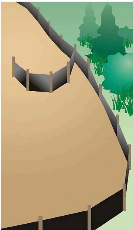
Para barreras contra sedimentos que tratan flujos elevados provenientes de pendientes pronunciadas, refuerce la barrera contra sedimentos con alambre tejido y postes metálicos. Instale una cerca de alambre entre los postes y la tela filtrante de la barrera contra sedimentos, de modo que la presión sobre la tela proveniente de los flujos ascendentes se distribuya a través de la cerca de alambre y luego a los postes.
