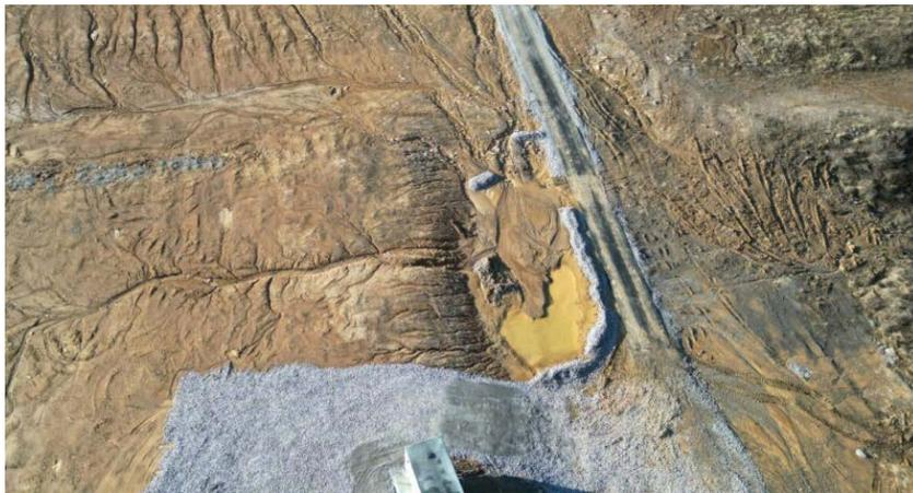
Buen diseño de la cuenca de sedimentos, pero la colocación inadecuada de las presas de control está provocando que el agua se desvíe de las presas. Además, la falta de siembra ha creado barrancos y los sedimentos están llenando rápidamente la cuenca.
