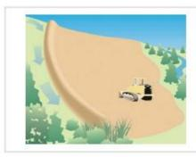
Las barrancas y los desfiladeros que desvían la corriente de tierras limpias alrededor de los sitios de construcción reducen los problemas de erosión y sedimentación. Barras de semilla y fosos después de la construcción.
